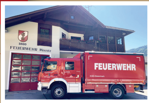
Logistik LKWA Mercedes Benz 1530 4x4 Besatzung 1:5, Platz für max. 9 Container
